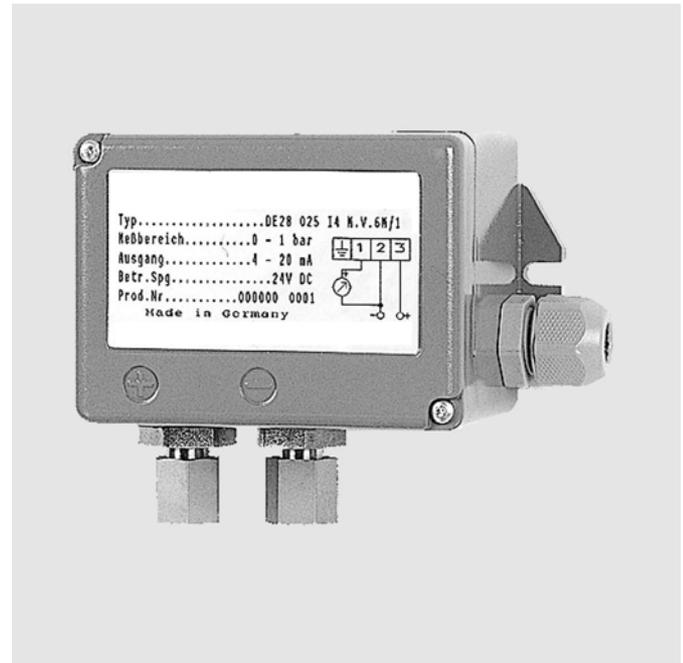
Die Bewegung des Membransystems wird über einen Stößel auf den Kern eines induktiven Wegaufnehmers übertragen und durch die nachgeschaltete Elektronik in elektrische Einheitssignale 0–20 mA / 4–20 mA linear / Dreileiteranschluss umgeformt.
