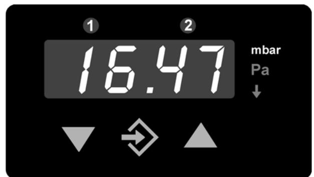
Die  $3\frac{1}{2}$  stellige LED-Anzeige stellt im Normalbetrieb den aktuellen Differenzdruck dar. Rechts von der Anzeige wird die gewählte Messeinheit hinterleuchtet. (Hinweis: Die auf dem Bild dargestellten Einheiten können von der tatsächlichen Ausführung abweichen.) Oberhalb der Anzeige symbolisieren die zwei Leuchtdioden ① ② den Zustand der Schaltausgänge (LED leuchtet = Schalter ist geschlossen).
